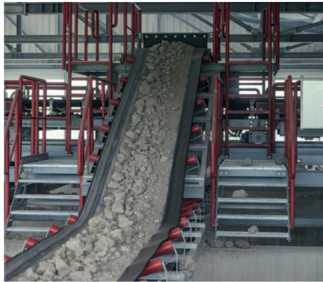
Über verschiebbare Einstreubänder wird der Ton dann in eine der 1.000 t fassenden Boxen eingelagert. Das neue Förderband ersetzt den dauernden Einsatz von 7 LKW für den Tontransport aus der Grube.
